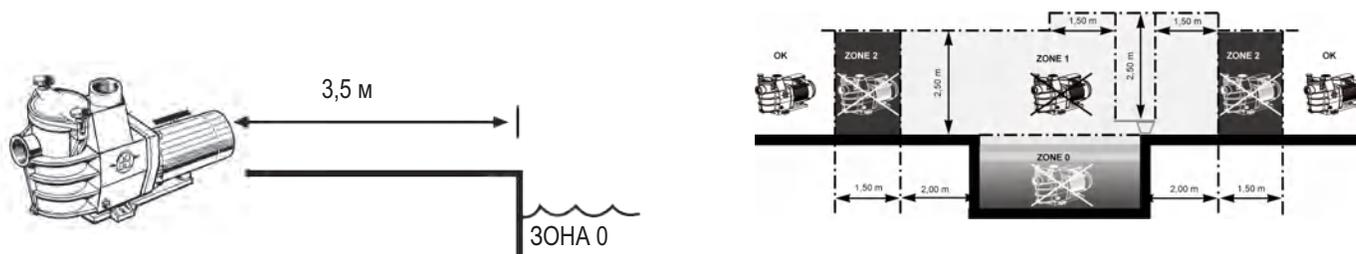
Установите насос в проветриваемом сухом месте. Для естественной вентиляции двигателя необходимо обеспечить свободную циркуляцию воздуха вокруг него. Необходимо периодически проверять, что охлаждению двигателя не препятствуют какие-либо объекты, листья и прочие предметы.
